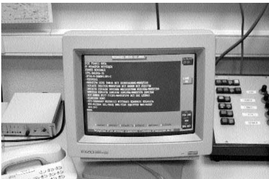
Le terminal RSFTA du BRIA Tahiti. United Airlines vient de lui faire parvenir un plan de vol Sydney- Los Angeles, qui va survoler la zone de contrôle de Tahiti.
