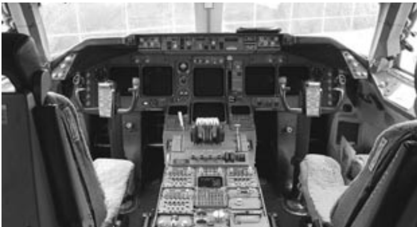
Le cockpit d'un avion Boeing 747 d'Air New Zealand équipé de boîtiers ACARS.
