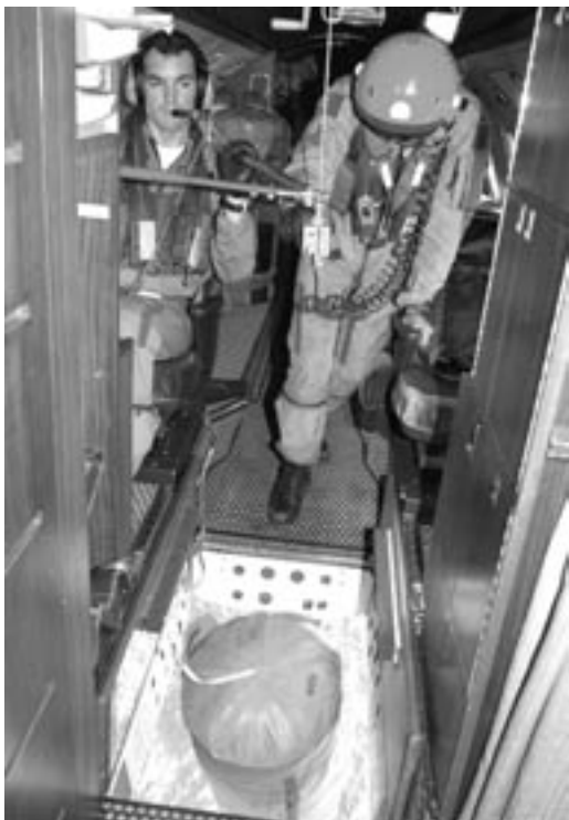
Les Gardian de la flottille 25F sont équipés d'une trappe qui permet notamment le largage des canots de sauvetage lors des opérations SAR.
